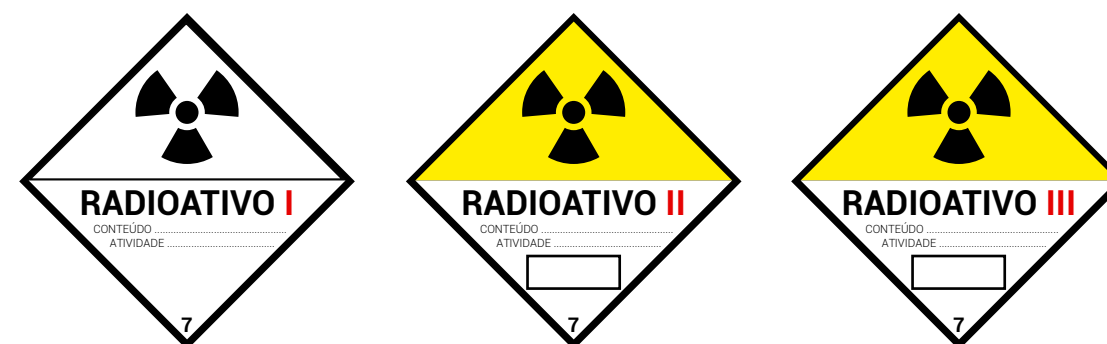
Etiquetas para transporte de materiais radioativos, conforme Norma 5.01
