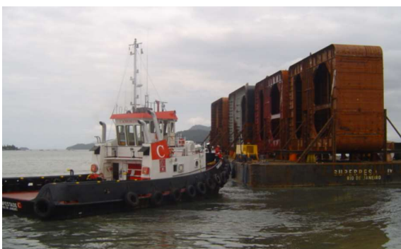
Fotos do load out dos blocos do carros de linha de eixo para balsa
