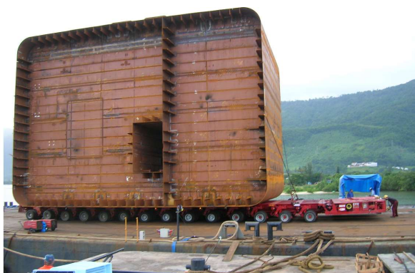
Fotos do load out dos blocos do carros de linha de eixo para balsa
