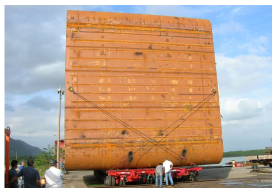
Fotos do load out dos blocos do carros de linha de eixo para balsa
