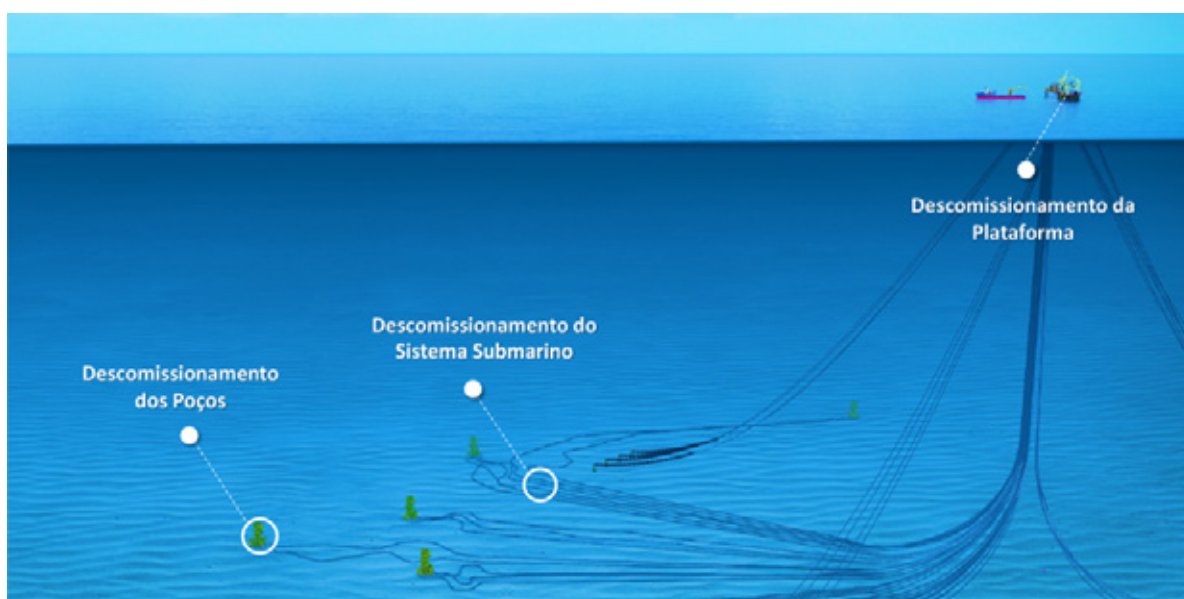
FIGURA 14: ESCOPO TÍPICO DE UM PROJETO DE DESCOMISSIONAMENTO DE SISTEMA DE PRODUÇÃO OFFSHORE DE ÓLEO E GÁS, DIVIDIDO NAS TRÊS GRANDES DISCIPLINAS/ÁREAS: PLATAFORMA, SISTEMA SUBMARINO E POÇOS.
